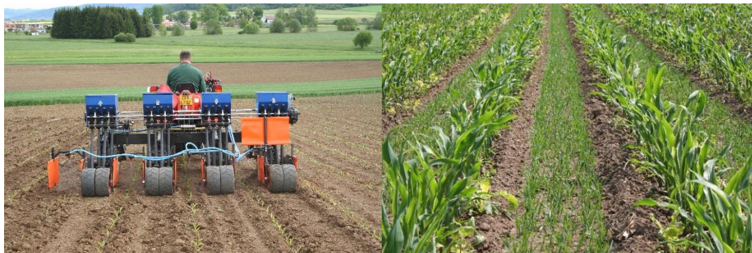
Obrázek 23 – Zakládání podsevů v maloparcelovém pokuse s kukuřicí multifunkčním strojem společnosti P&L, spol. s r.o. (Jevíčko 2021) (vlevo) a podsev pšenice ozimé v meziřádku kukuřice 2 týdny po setí (vpravo).
