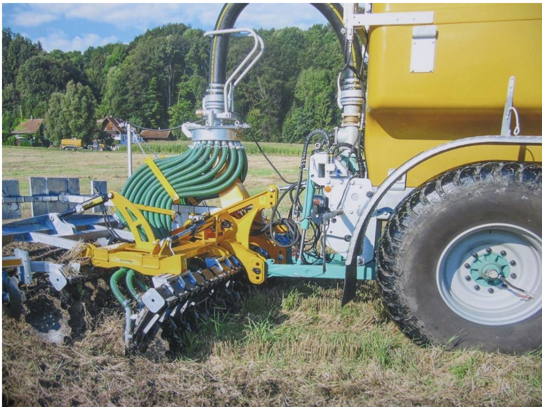
Obr. 1: Aplikace digestátu na strniště s výdrolem a rozdrčenou slámou se zapravením disky
